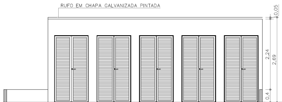
Imagem: Vista da fachada do abrigo de resíduos
